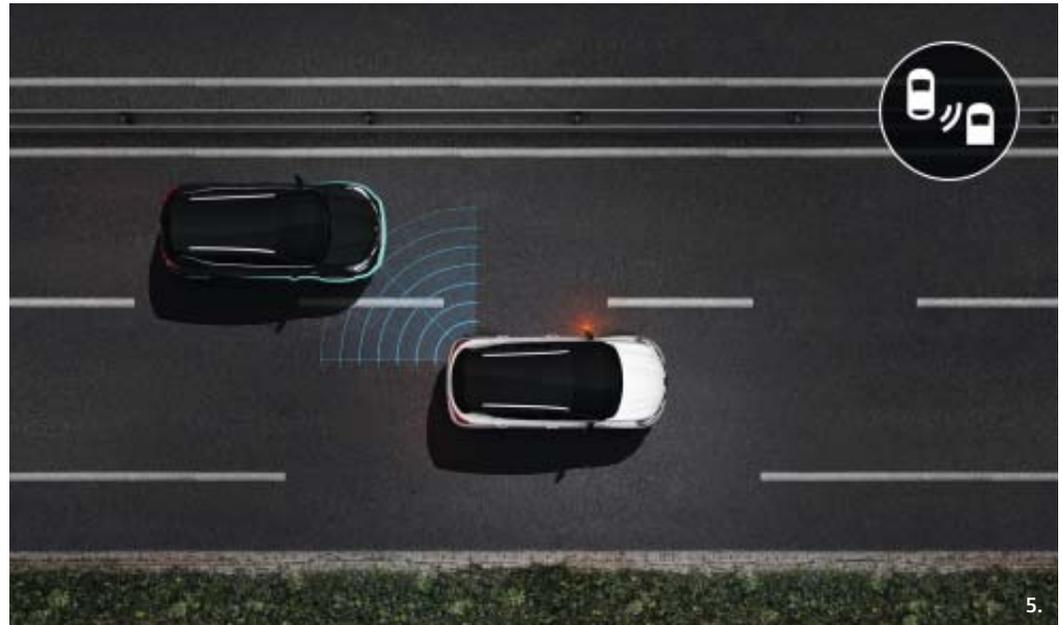
**5. Détecteur d'angle mort.** Un indicateur lumineux situé sur chacun des rétroviseurs extérieurs vous alerte lorsqu'un véhicule se trouve dans la zone d'angle mort.
